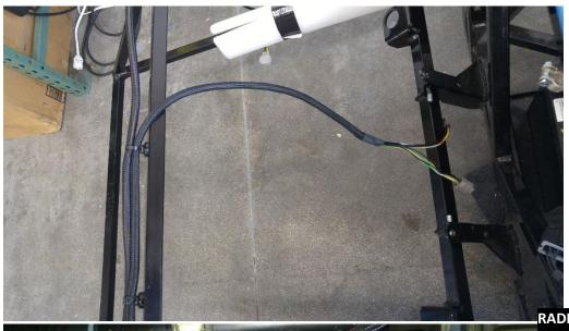
RADIATOR FAN PLUGS CAN BE REROUTED TO THE CENTER
